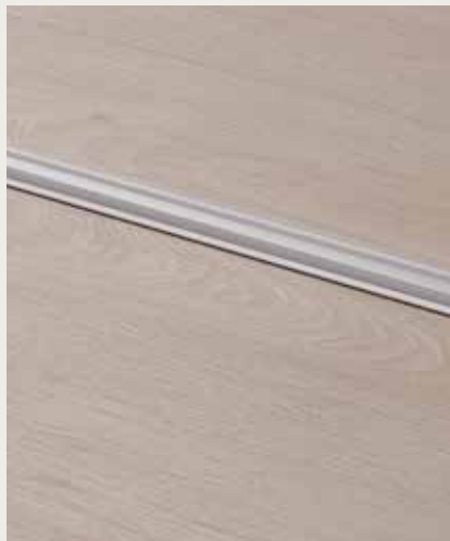
MULTIFUNCTIONEEL PROFIEL ZILVER 1860 × 47 × 16 mm Uitzettings- en aanpassingsprofiel in één. Geschikt voor hoogteverschillen van 0-12,3 mm. Hoogte: 10 mm (niet geplaatst). Aluminium. PGPRSILV
